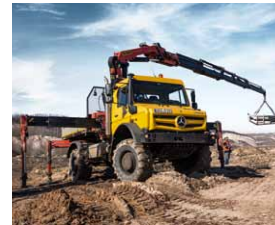
Leistung abseits befestigter Straßen und Wege durch Motor- und Getriebe-Nebenabtriebe.
